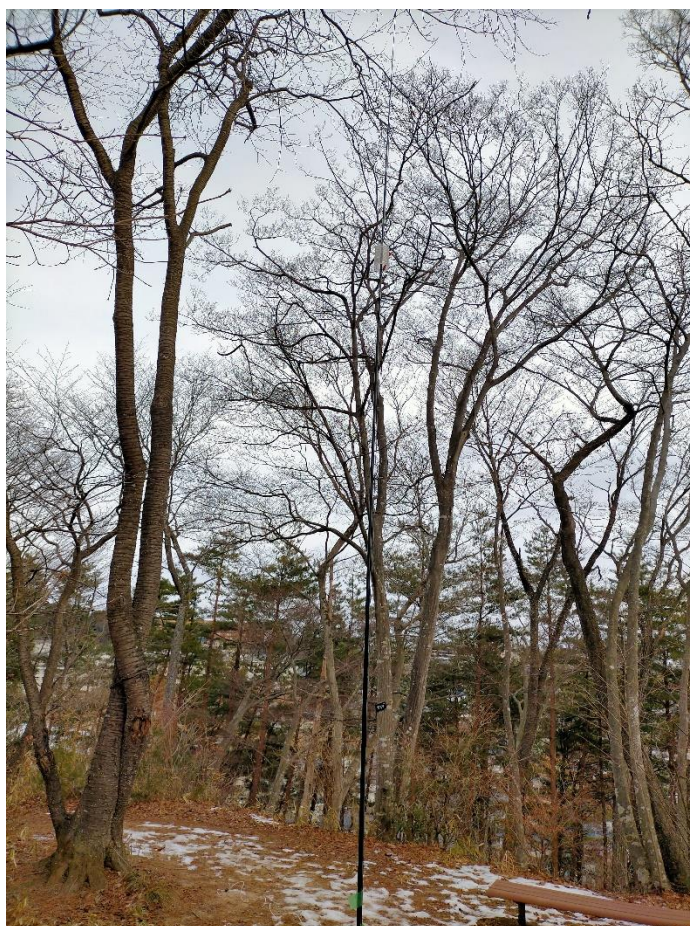
図 1 設営した釣り竿アンテナの様子
