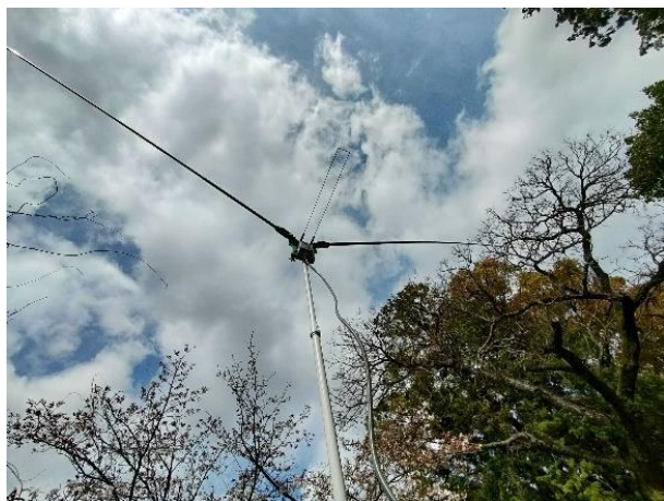
図 8 設営したダイポールアンテナ
