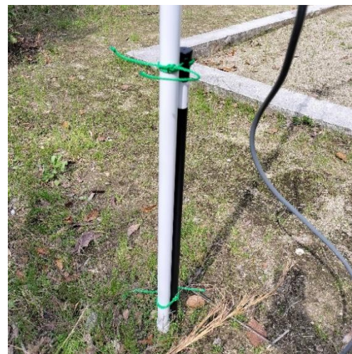
図 7 地面に打ち込んだ杭
